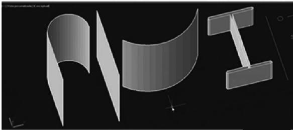
Como recordarás en el caso de los sólidos, para extruir un objeto, simplemente lo indicábamos y luego podíamos capturar un valor de altura, o bien indicamos otro objeto que sirva de trayectoria. Si usamos un perfil cerrado, el resultado puede ser un sólido o una superficie según definamos y si es un perfil abierto, éste por definición siempre será una superficie.
