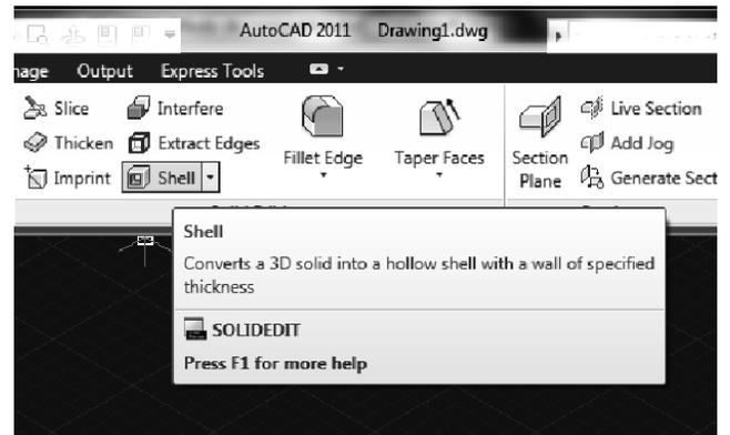
Valores de grosor positivos crean la funda hacia el interior del sólido, valores negativos hacia el exterior. Este comando no puede aplicarse sobre otras fundas.
