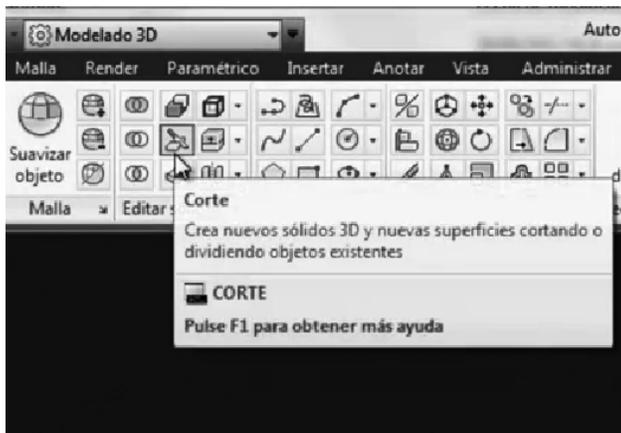
Como su nombre lo indica, con este comando podemos cortar un sólido cualquiera especificando el plano de corte y el punto en el que dicho plano se va a aplicar. También debemos elegir si una de las dos partes se elimina o si se mantienen ambas. La ventana de comandos muestra todas las opciones disponibles para definir los planos de corte, o bien cómo usar otros objetos que definan dichos planos.
