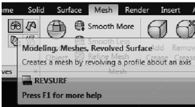
Las mallas revolucionadas se generan haciendo girar un perfil sobre un eje, creando así las caras de la malla. Al perfil se le llama curva de trayectoria, al eje, eje de revolución, el cual debe ser una línea o el primer tramo de línea de una polilínea. De forma pre-determinada, el perfil gira los 360 grados, generando un objeto 3D cerrado, pero podemos indicar un ángulo de inicio y otro final, que no necesariamente tienen que ser 0 y 360 grados.
